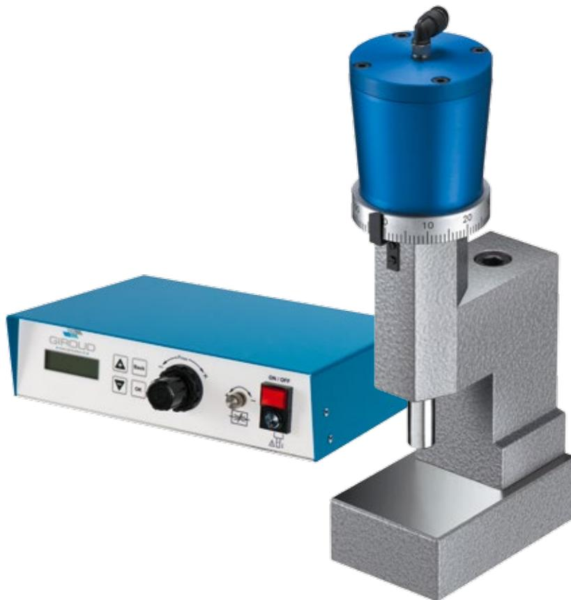
Das Basispresse System besteht aus einer Presse und eine Steuerung mit einer einfachen „**START**“ Auslösung (Aktivierung des Zyklus der Presse durch die Schließung eines Kontaktes NO.). Es ist möglich, Sicherheits Versionen der Steuerung mit Zweihandsicherheits System zu erhalten. GIROUD SA schlägt zwei Varianten Zweihandsicherheits Bedienung vor mit mechanischem Taster oder mit sensitivem Taster.
