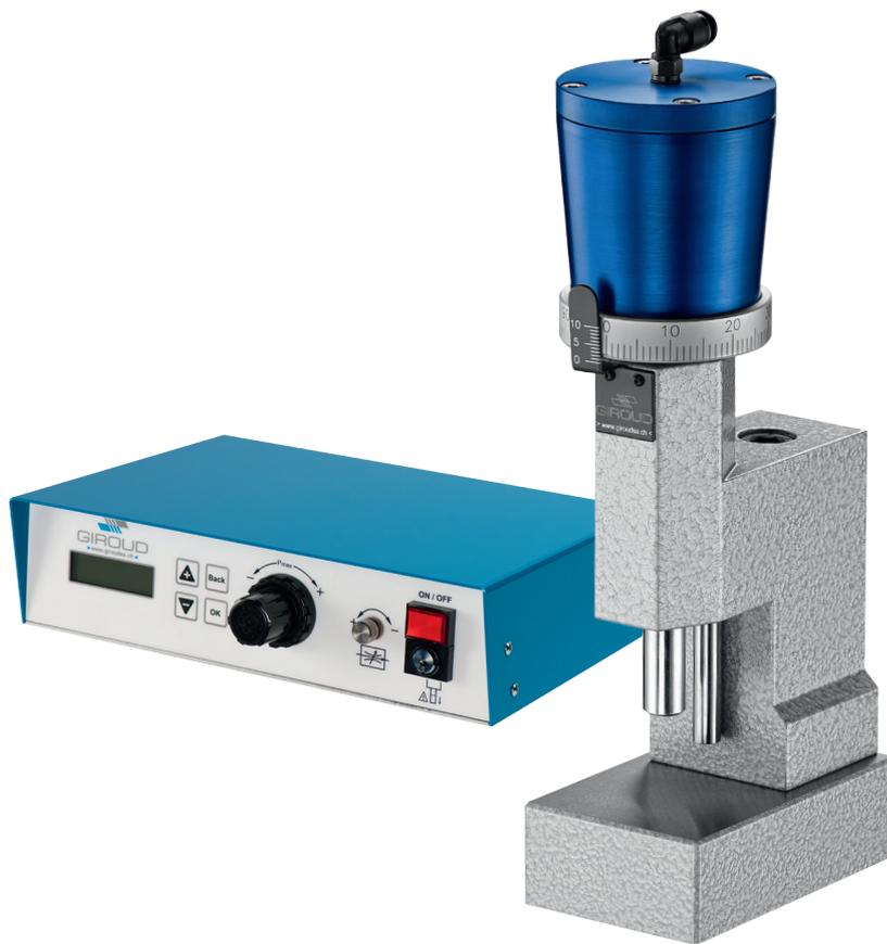
Le système de presse de base est constitué d'une presse et d'un boîtier de commande avec «**START**» simple (activation du cycle de la presse par la fermeture d'un contact NO). Il est possible d'obtenir une version sécurisée du boîtier avec une commande bi-manuelle. GIROUD SA vous propose une solution avec des boutons sensitifs «effortless» (chapitre 6.3)
